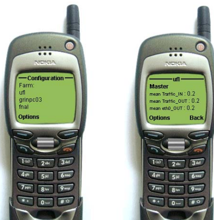
Figure 8. Mini client: WAP enabled mobile phone: WML content
